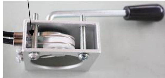
ボルトの悪い取付け方（ワイヤーにあたる）
